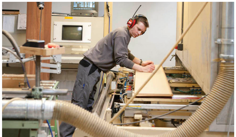
Vor dem abschließenden Falten des Gehäuses werden V-förmige Schnitte an den Kanten der MDF-Platten eingebracht.
