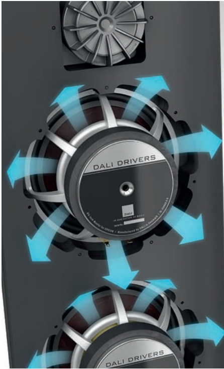
Eine spezielle Fräsung der Einbauöffnungen für die Tieftöner schafft mehr Raum zwischen den Schraubbefestigungen und ermöglicht dadurch einen ungehinderten Luftstrom hinter den Bass-Treibern.
