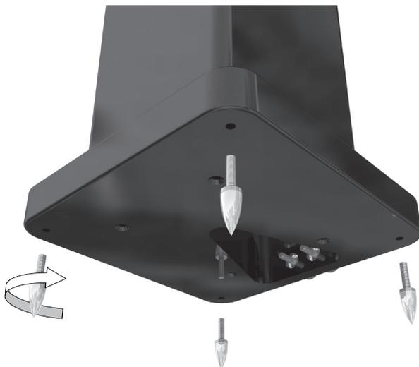
Nehmen Sie die Stifte und drehen Sie diese im Uhrzeigersinn in die Sockel. Prüfen Sie den festen Sitz, stellen Sie das Gehäuse auf und platzieren Sie es am endgültigen Standort. Für eine ebene Ausrichtung passen Sie die Stifte entsprechend an, ehe Sie die Rändel-Sicherungsmutter festziehen, um die Stifte in der entsprechenden Position zu halten.
