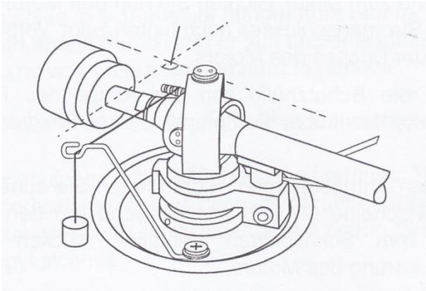
den Tonarm über eine Langspielplatte (Tonarmlift (7) angehoben lassen) in etwa in die Mitte der bespielten Fläche. Nun sollte das Tonarmrohr und der Faden zwischen Antiskatingfinger (15) und –Rute (17) in etwa im 90°-Winkel zueinander sein. Zur Korrektur darf die Rute in die korrekte Position gebogen werden.
