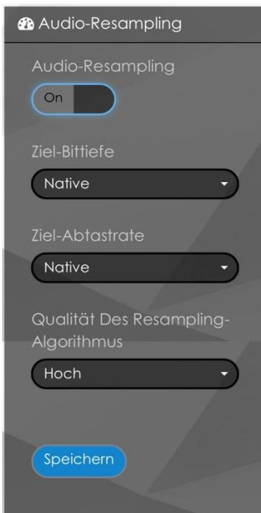
Audio-Resampling ist eine Funktion, die den ausgehenden Datenstrom auf die Möglichkeiten des nachfolgenden D/A-Wandlers anpasst. Konsultieren Sie hierzu die technischen Daten Ihres USB-DACs und wählen Sie die höchstmöglichen Werte.
