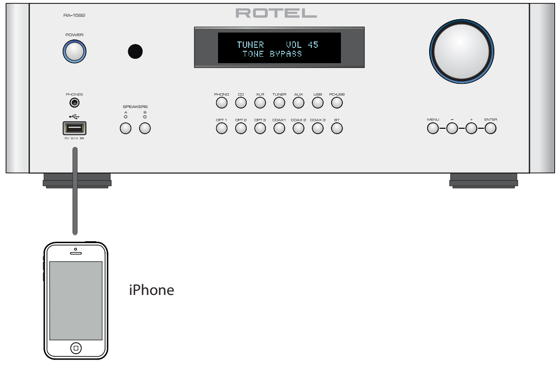
Figure 6: Front USB Input Entrée USB en face avant Frontseitiger USB-Eingang Entrada USB Frontal
