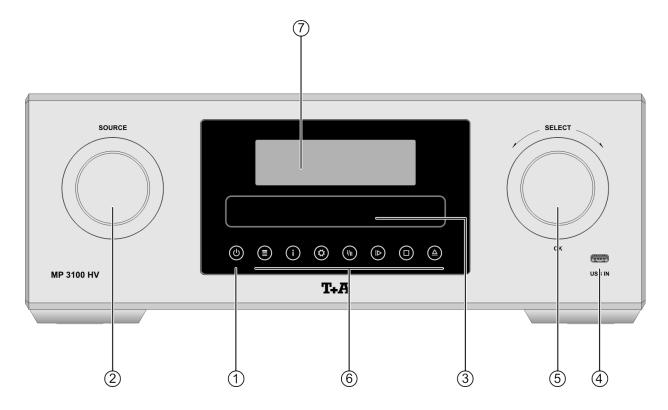
Mit den Tasten und Drehknöpfen an der Gerätefront können alle wichtigen Funktionen des MP 3100 HV bedient werden. Für die Quellenwahl und Navigation / Steuerung stehen die großen Drehknöpfe zur Verfügung. Seltener benötigte Funktionen werden über ein Menü bedient, welches über die ③ -Taste aufgerufen wird.
