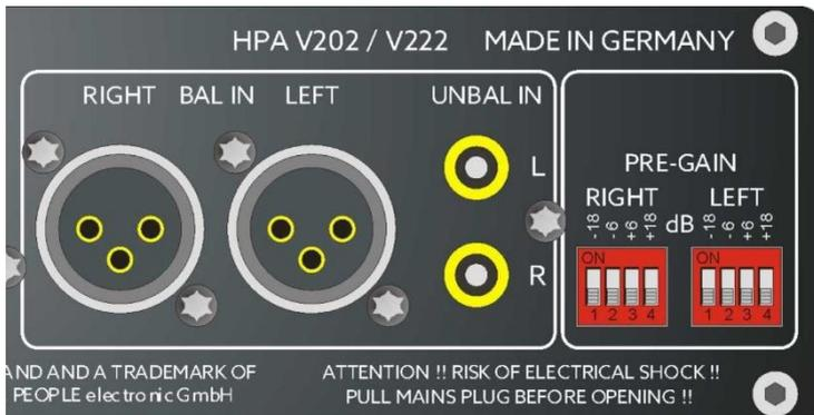
Die Eingangsimpedanz an den analogen Eingängen beträgt 10 kOhm. Der maximale Eingangsspegel sollte +21 dBu nicht überschreiten. Dieser Wert vermindert sich auf bis zu +3 dBu wenn **PRE-GAIN** auf +18 dB geschaltet ist!
